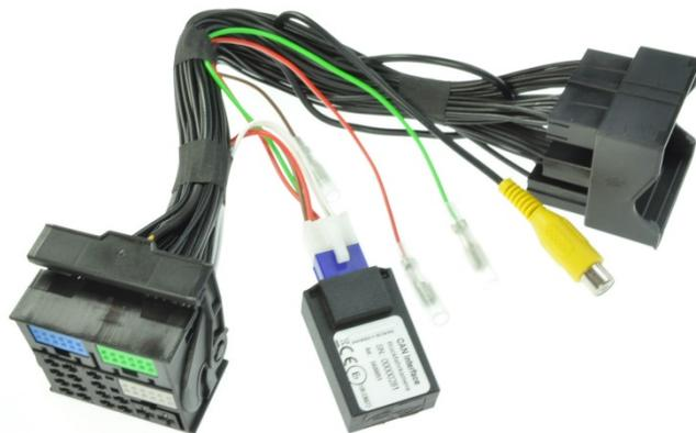
Plug & Play Installation - keine Modifikation am originalen Fahrzeugkabelbaum nötig! Liefert alle nötigen Signale – kein lästiges Suchen und Kabelziehen!
